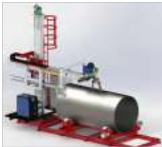
Longitudinal seam welding
